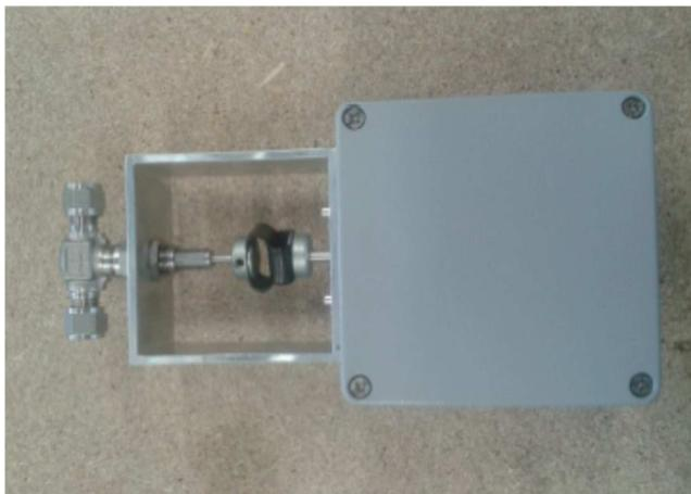
Figura 27. Sistema de control de presión de reacción.
