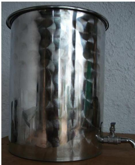
**Figura 20. Depósito 50 litros aceite residual.**
