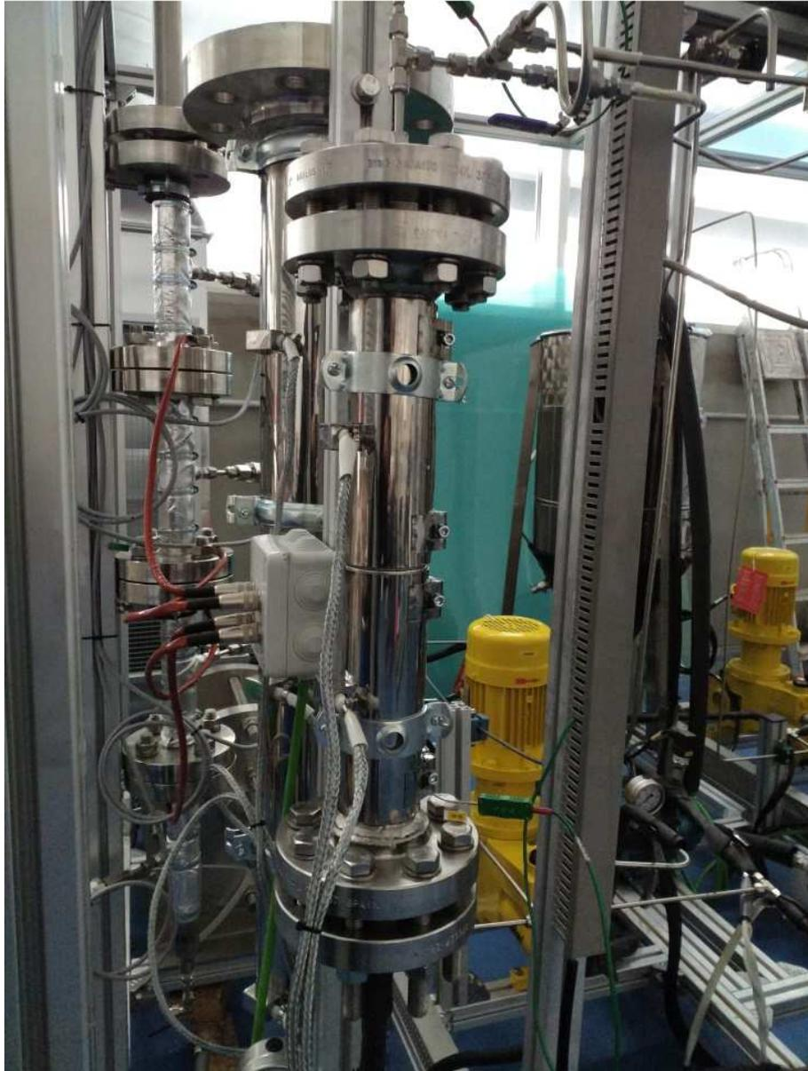
Figura 38. Reactor estático de 1 l de capacidad con 2 placas de orificio.
