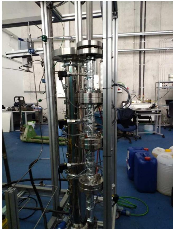
Figura 37. Reactor estático de 4 placas y de 2 placas para caudales elevados.
